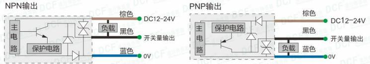
温馨提示: NPN输出为低电平, 即为0V; 此时接PLC时, PLC公共端为高电平, 常规接24V。
