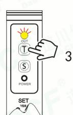
1.按下“T”按键>3s, 之后松开。POWER指示灯闪烁10秒；进入10秒自校准状态 (在此状态下滑动标签)，待校准结束后便可正常工作，校准后OUT指示灯正常工作。
